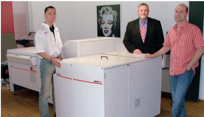
Marcus Werner (Technik Druckvorstufe, l.) mit Rudolf Tippner (Leiter Kommunikation Agfa) und Haimo Barthel vor dem Palladio 30 (mit Online-Processor LP 68 Ultra). Mit dem CtP-System können pro Stunde bis zu zwanzig Silberhalogenid-Druckplatten im Vier-Seitenformat hergestellt werden.
